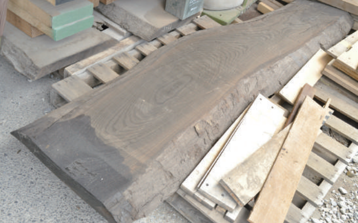
↑神代ケヤキの板材。長い時間を経て褐色に変化していることが隣の木材と比較してよくわかる。
