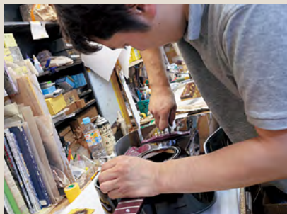
リーマーを使い、ブリッジのピン穴を調整する作業。
