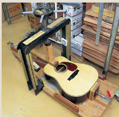
①ボディにネックをセットする際に利用するジャッキ。
