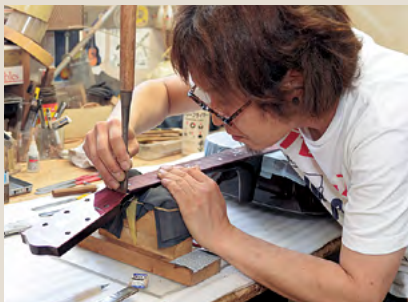
ノミを使い、ナット溝を加工/調整する作業。
