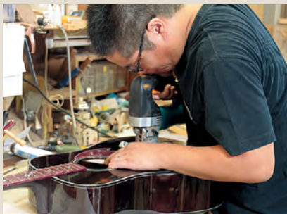
ブリッジのピン穴に、弦の通る溝を切削機械で加工する安井。
