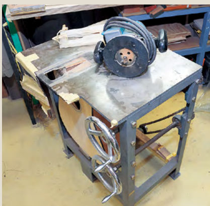
②ボディ側のアリミゾ加工をするためのジグと固定台。
