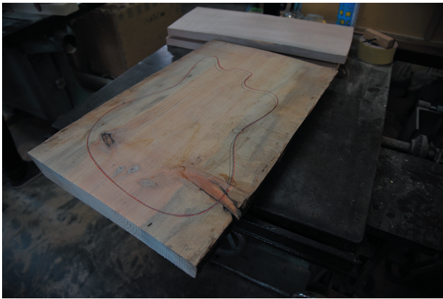
木材が持つ節や穴をそのまま活かす木取り。敢えてギターの中でも目立つ部位に節がくるように型をあて、線を引く。
